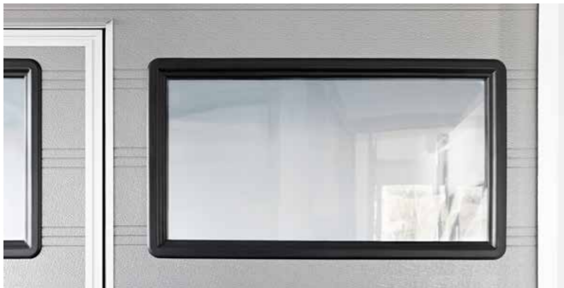
Thermisch getrennter Kunststoffrahmen Fenster: 775x430 mm; Lichtöffnung: 695x350 mm Telaio oblò a taglio termico Telaio: 775x430 mm; apertura trasparente: 695x350 mm
