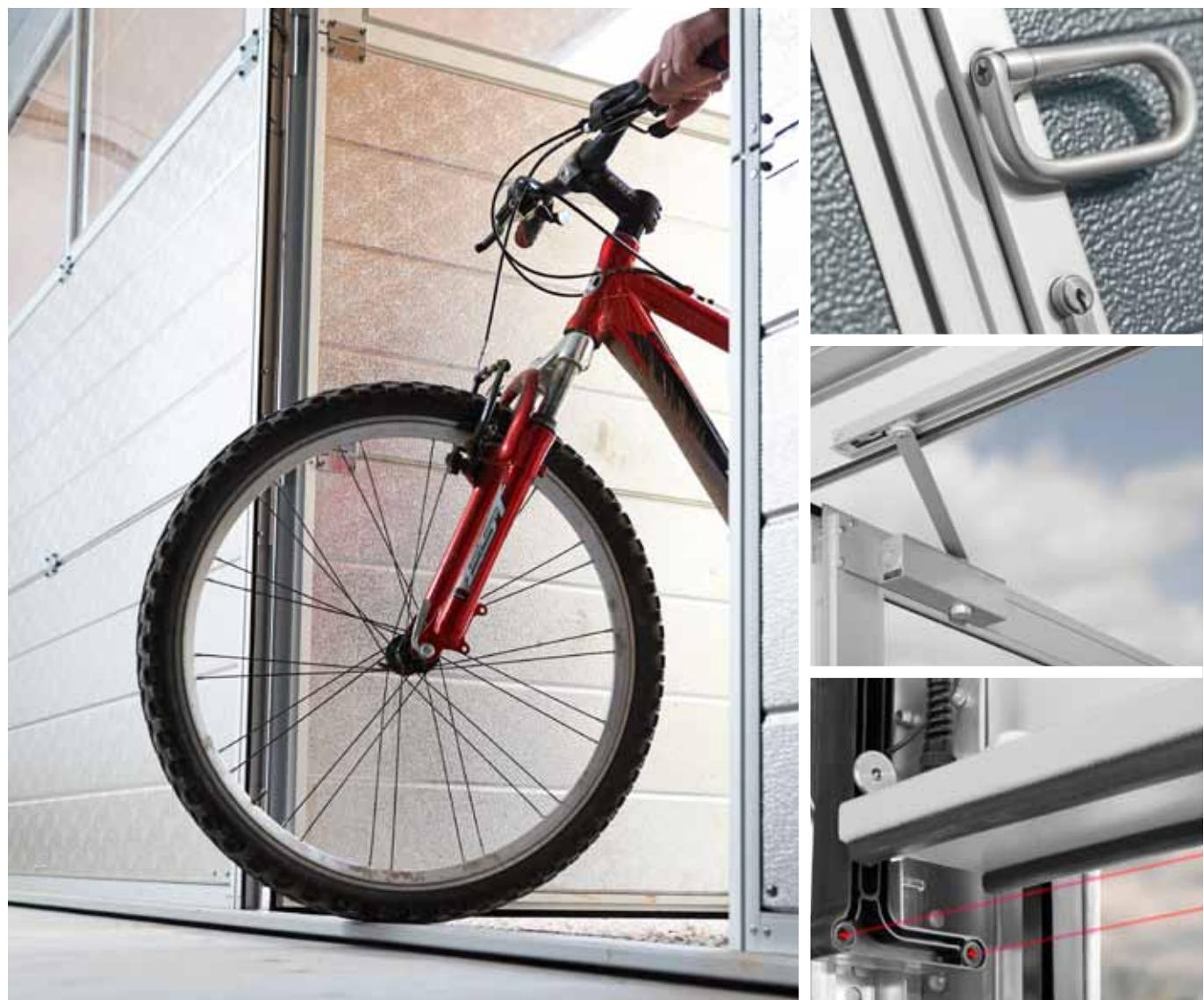
» Der Einbau einer Schlupftüre ermöglicht einen Zugang zur Garage, ohne dass das gesamte Torblatt hochgefahren werden muss. Die integrierten Türen fügen sich harmonisch in das Gesamtbild ein und bieten dank der doppelten Dichtungen auch eine optimale Dichtheit. Die neuartige Niedrigschwelle mit nur 23 mm Höhe eignet sich gerade dort, wo durch häufiges Betreten und Verlassen die Stolpergefahr minimiert werden soll und ist auch als Fluchttür mit Antipanikbeschlag erhältlich.
